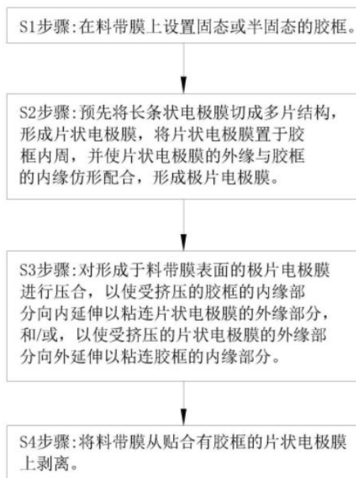
图16：固态电池极片胶框覆合方法
