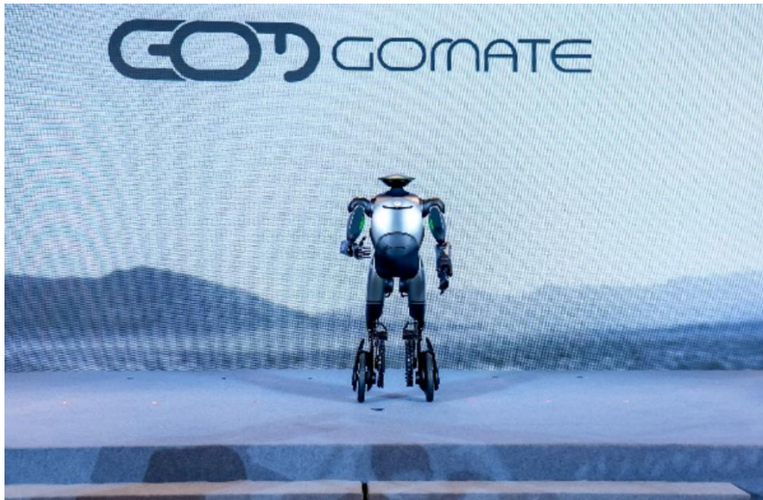
图3：广汽集团第三代人形机器人GoMate，搭载固态电池续航达到6小时
