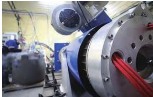
图31: 俄罗斯超导混合动力电驱项目 Yak-40 电机测试实验
